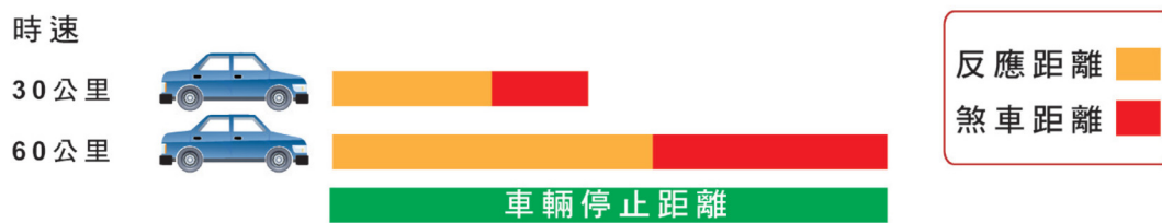
圖14 行車速度愈高，車輛停止距離愈大 [10]
